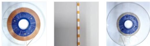
TAB 자재 표면에 절연 테이프 부착 or 2D 바코드 laser 마킹하여 성능 향상
